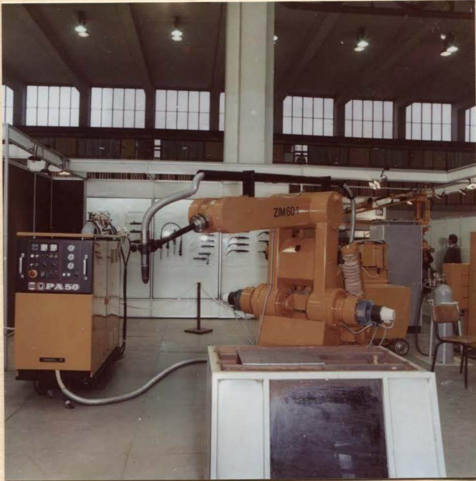
Ein neuer Arbeitsplatz: Mikroelektronisch gesteuerte Plasmaanlage PA 50 mit Industrieroboter ZIM 60. Ein Spitzenerzeugnis des VEB Schweißtechnik Finsterwalde.
