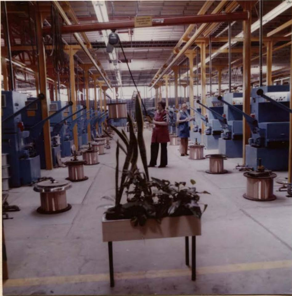
Im VEB Walzwerk Hettstedt werden auf der Basis neuer hocheffektiver Technologien Kupferblank- und Kupferlackdraht in feinsten Abmessungsbereichen für die Elektronik und Elektrotechnik produziert.
