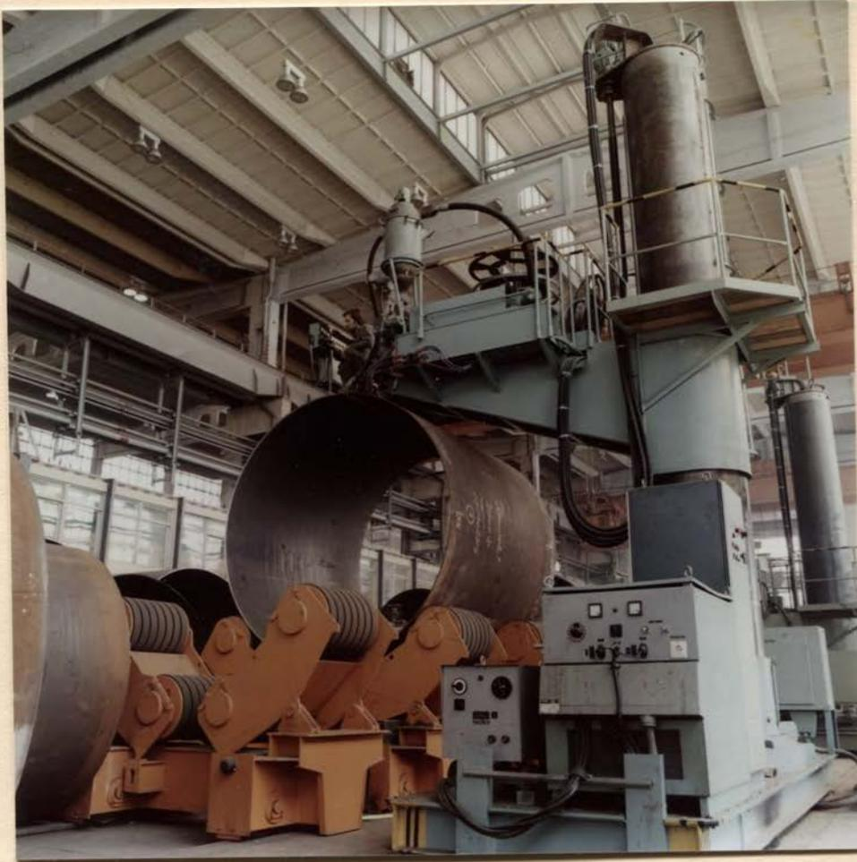
Mit dieser Schweißanlage, die in unserem Kombinat entwickelt wurde und produziert wird, werden Schweißarbeiten auch bei komplizierten Positionen rationell und automatisch durchgeführt.
