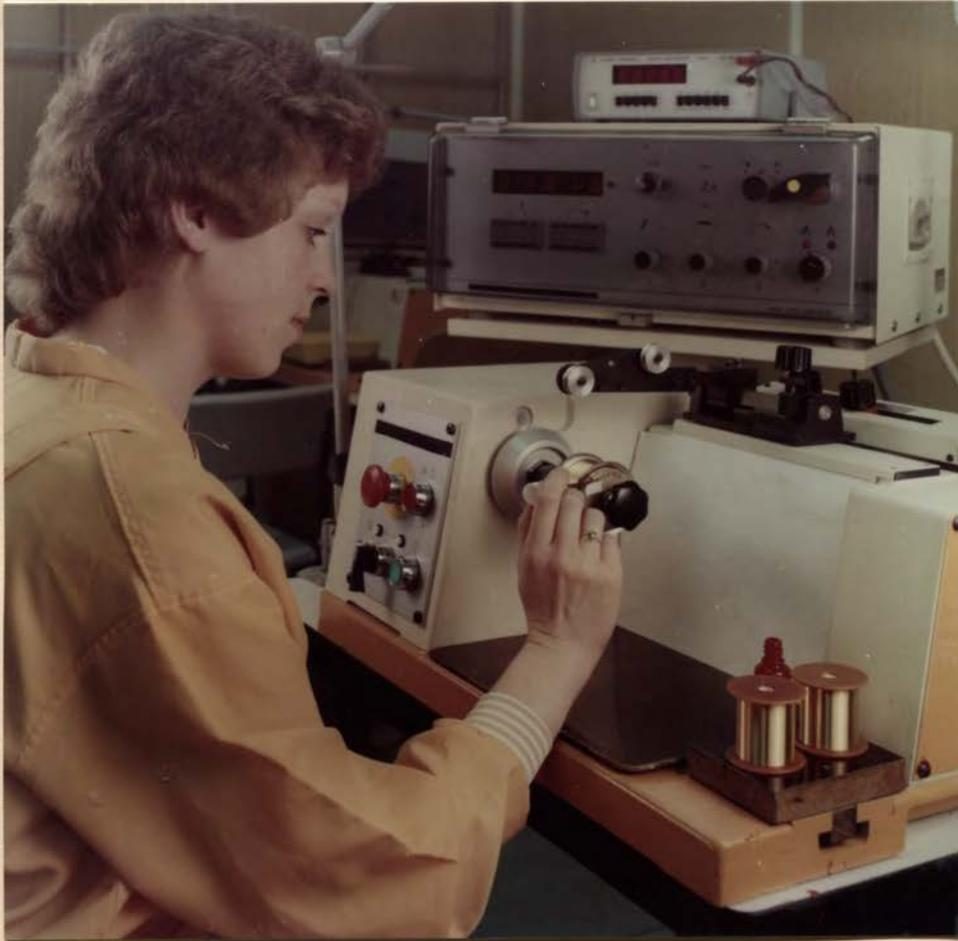
Das Mansfeld Kombinat schafft entscheidende Voraussetzungen für die Durchsetzung des Mikroelektronikprogramms in der DDR und innerhalb des RGW. An dieser Präzisionsziehanlage wird Goldbonddraht von höchster Qualität für die Herstellung von Schaltkreisen für die Mikroelektronik produziert. Unser Goldbonddraht ist ein Spitzenprodukt der DDR-Metallurgie.
