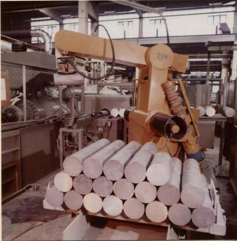
Stapelroboter für Al-Preßrohlinge lösen schwere körperliche Arbeit im VEB Leichtmetallwerk Rackwitz ab.
