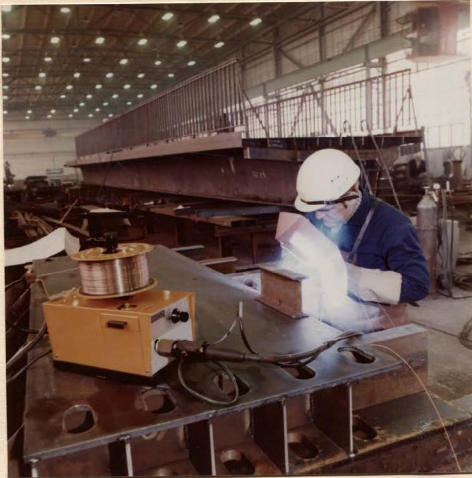
Das MIG/MAG Schweißgerätesystem MSG 60 ist ein Produkt unseres Kombinats. Hohe Produktivität, geringer Arbeitskräfteaufwand und erstklassige Schweißtechnik zeichnen es aus. Seine raumsparende Bauweise, Variabilität und Universalität sowie der Einsatz elektronischer Steuerungen sind weitere Kriterien für diesen Halbautomaten einer neuen Generation.
