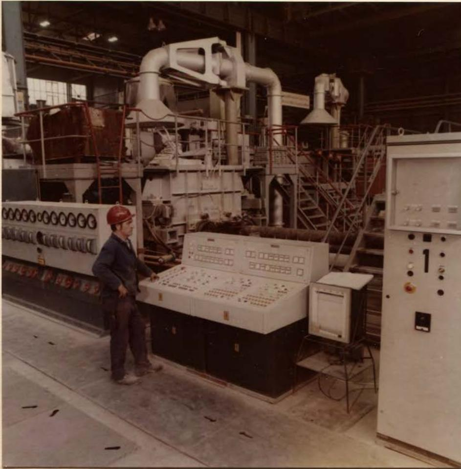
Das Steuerpult der Messing-Bolzen-Gießerei. Dieses hocheffektive Verfahren senkt die Selbstkosten und führt zur Produktionssteigerung bei gleichzeitiger Qualitätsverbesserung.
