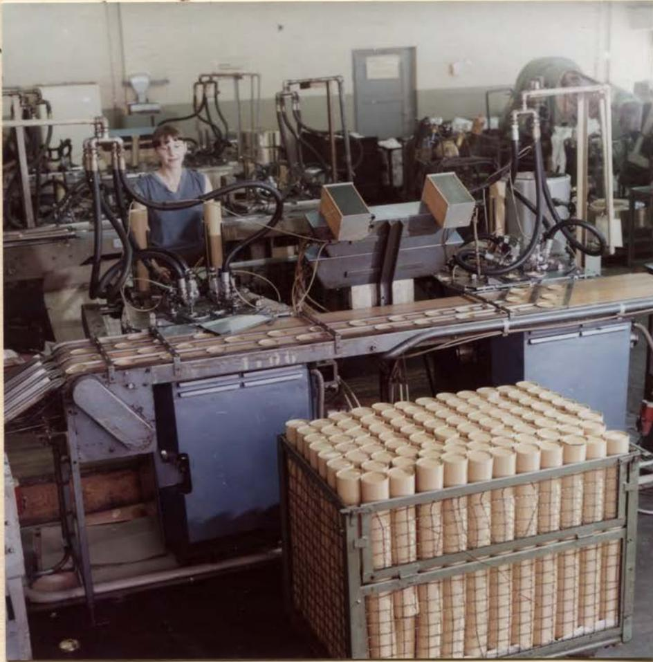
Herstellung von Glasverschlüssen des Typs Uni 83/7 mm auf modernen Fertigungs-
