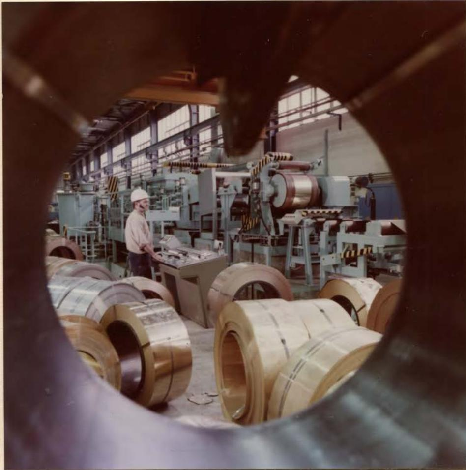
Die Werktätigen unseres Kombinats produzieren mit modernsten Maschinen hochwertige engtolerierte Bänder aus Kupfer, Messing und Neusilber. Sie haben die Schwermetallschmalbandproduktion erweitert. Unser Bild: Bei der Herstellung von Kupfer- und Messingschmalband im VEB Walzwerk Hettstedt.
