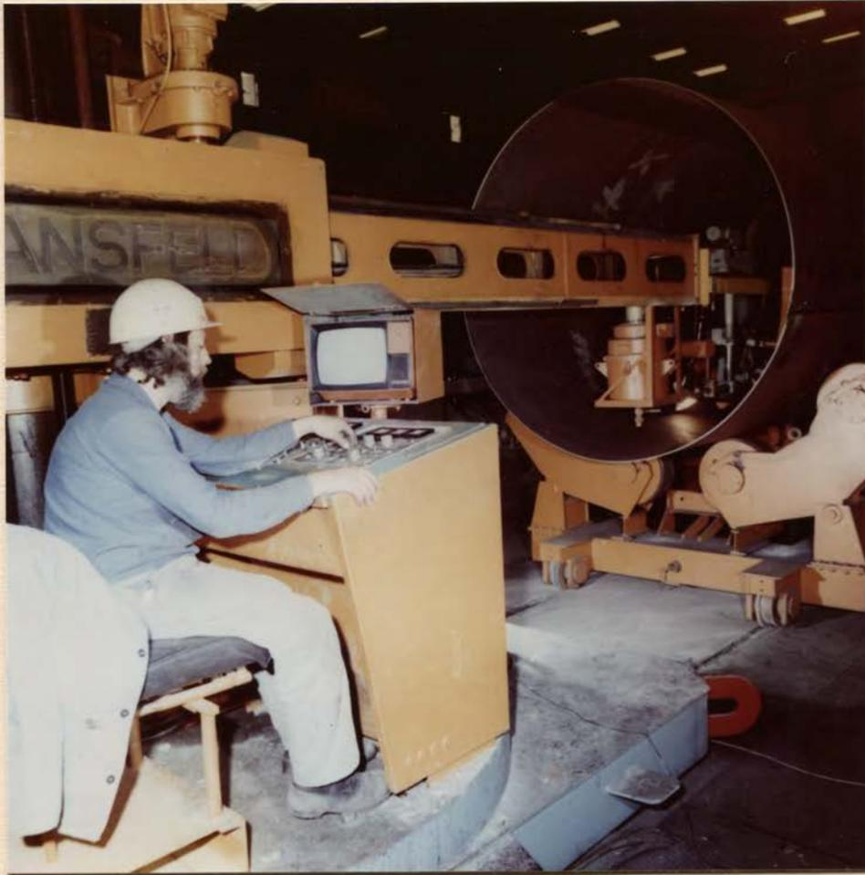
Moderne Technologie erleichtert die Arbeit und schafft hohe Arbeitsproduktivität: Schweißmast für UP-Innenschweißung in Behältern und Apparaten für emaillierte Großbehälter im VEB EHW Thale.
