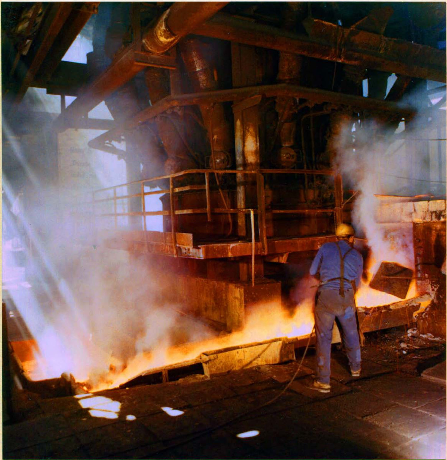
Mehr Kupfer für unser sozialistisches Vaterland – die Deutsche Demokratische Republik! Kupferabstich in der August-Bebel-Hütte.
