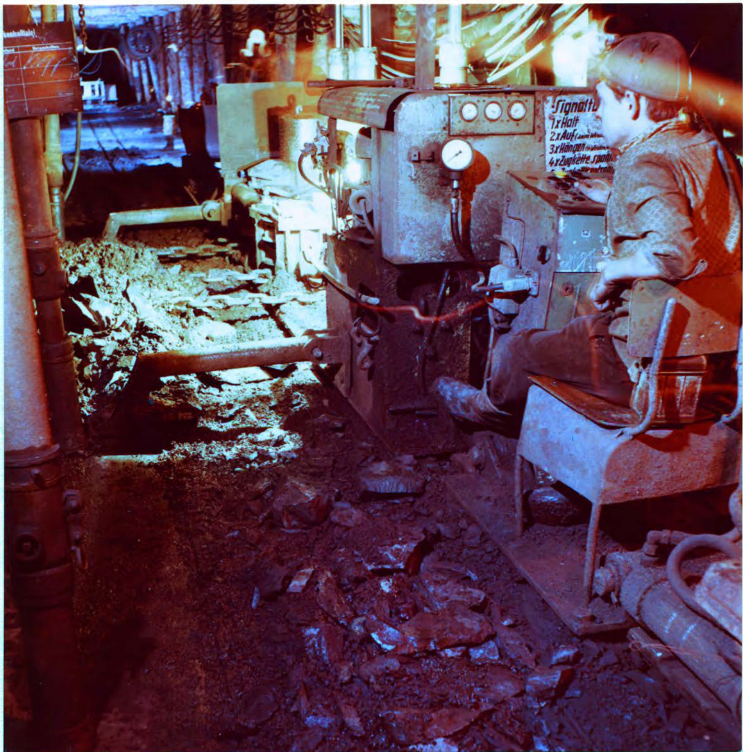
Mechanisierung senkt die ehemals schwere körperliche Arbeit im Kupferbergbau erheblich und dient der Rationalisierung im Bergbau: Abbau von Kupfererz durch moderne Schälscraper.
