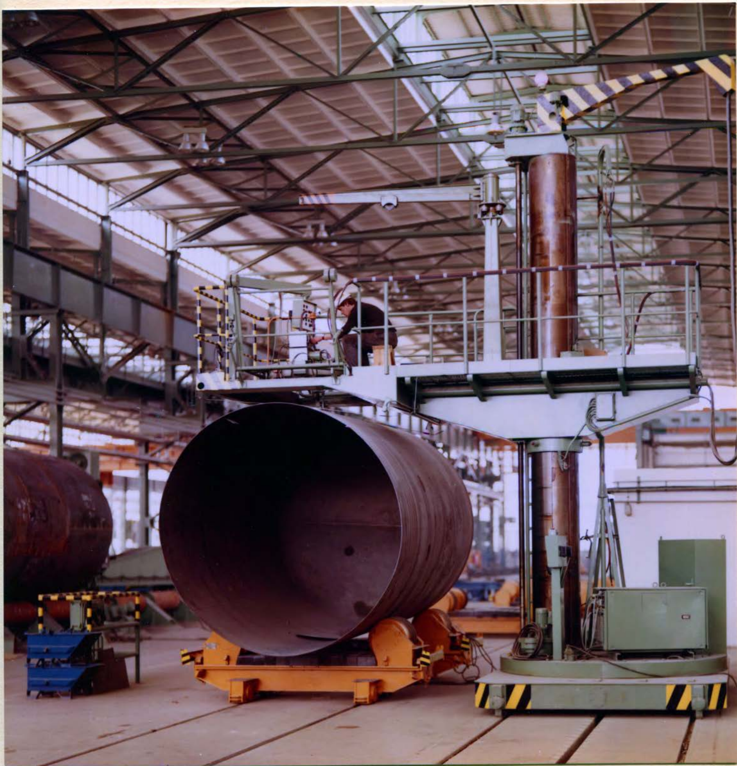
Mit automatischen Schweißanlagen, die in unserem Kombinat entwickelt und produziert werden, tragen wir mit zur Rationalisierung von Schweißarbeiten und so zur raschen Steigerung der Arbeitsproduktivität im Sinne des Wettbewerbes zu Ehren des 30. Jahrestages der DDR bei.
