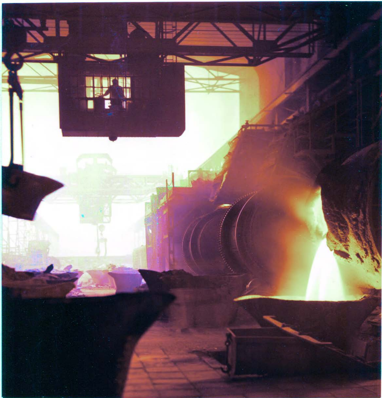
Bevor das Kupfer der Industrie zur Weiterverarbeitung angeboten werden kann, muß es mehrere Produktionsstufen durchlaufen, unter anderem die Bessemerei der Kupfer-Silber-Hütte „Fritz Beyling“.
