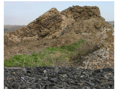
Abb. 6: „Ungebrannte“ und „gebrannte“ Schiefer auf der Ausschlägehalde des Glückhlf-Schachtes Foto: Dr. König
