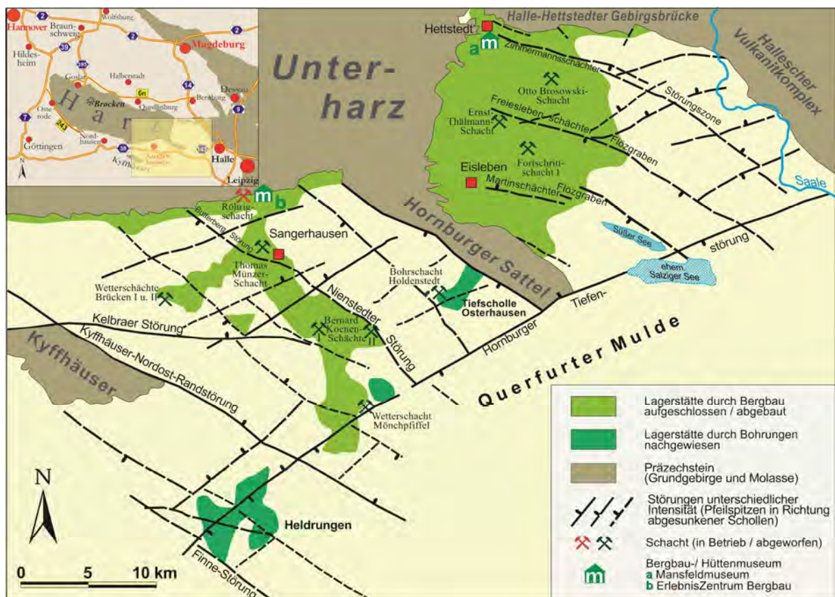
Abb. 1: Übersichtskarte der Reviere des Kupferschieferbergbaus im Mansfelder Land. (verändert nach STEDINGK & RAPPSILBER 2000).
