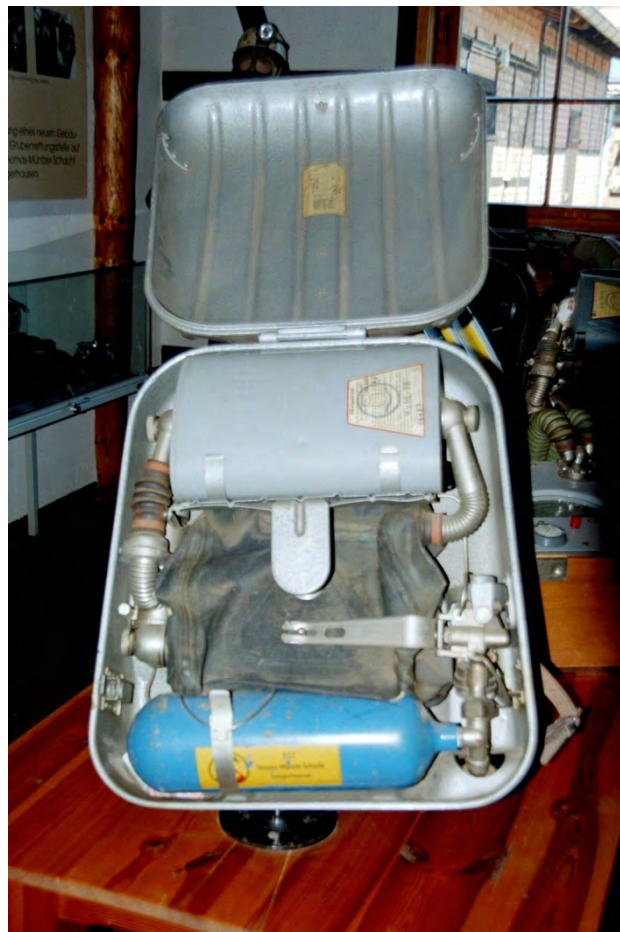
Abb. 19 : Blick in ein geöffnetes Kreislaufgerät mit Sauerstoffflasche (blau), Atembeutel und Alkalipatrone (oben)
