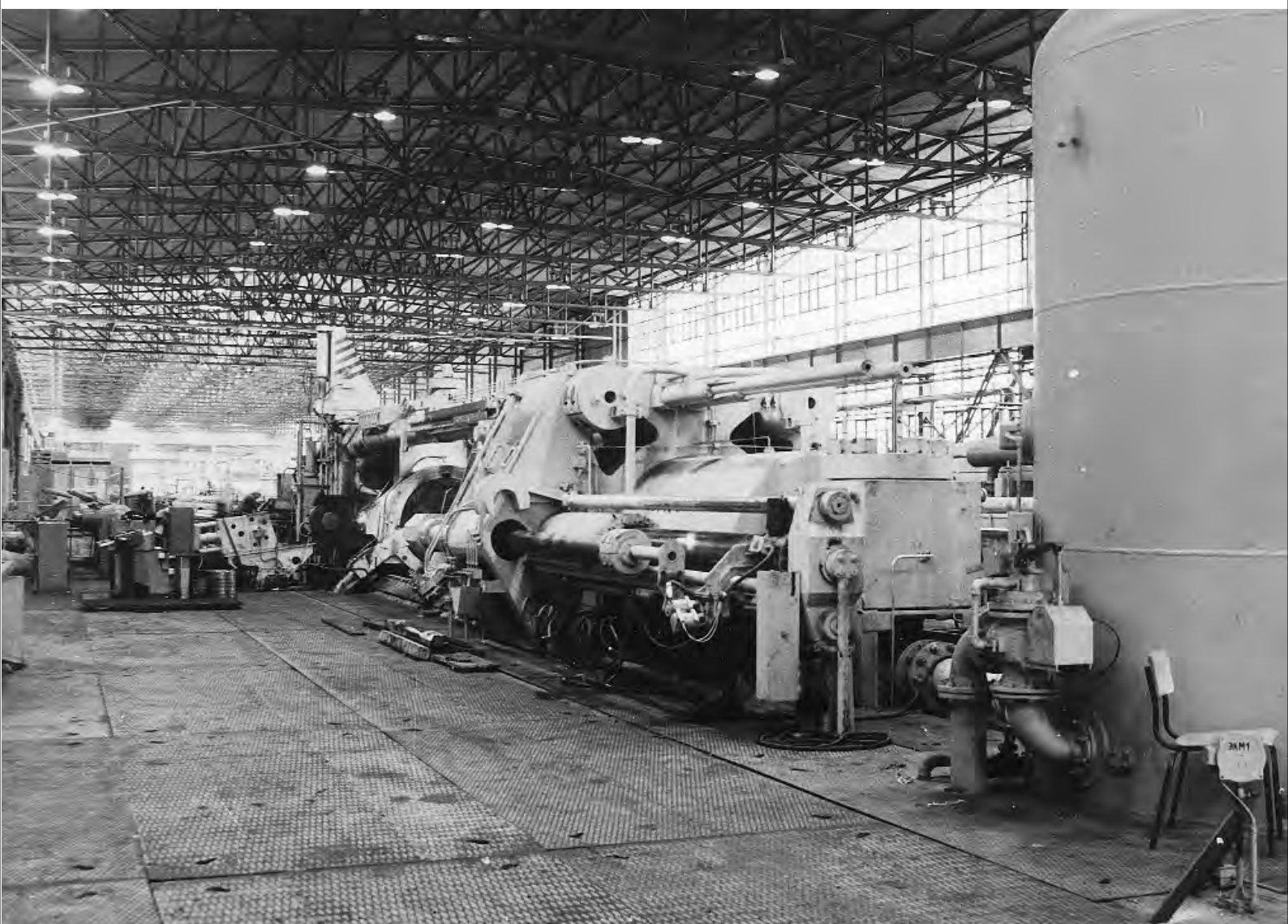
Die 30,5 MN-Pressen stammt aus der UdSSR – Maschinen- baubetrieb Kolomna
