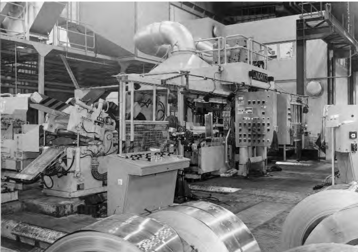
oben: Das so genannte „Andritz“-Quarto im Bandwalzwerk II – ebenfalls eine internationale Kooperation der DDR mit Österreich
