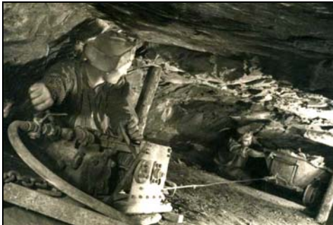
Förderung des Huntes mittels Drucklufthaspel vor Streb
